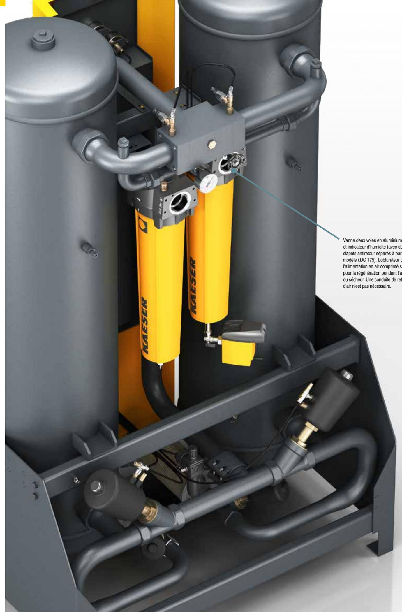
Vanne deux voies en aluminium et indicateur d'humidité (avec des clapets antiretour séparés à partir du modèle i.DC 175). L'obturateur permet l'alimentation en air comprimé sec pour la régénération pendant l'arrêt du sécheur. Une conduite de retour d'air n'est pas nécessaire.
