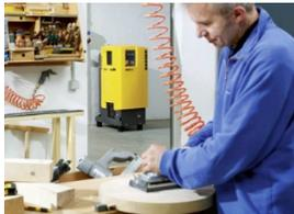
La station d'air comprimé SXC associe, dans un espace minimal, un compresseur à vis, un sécheur frigorifique et un réservoir d'air comprimé de 215 litres. Son niveau sonore maximal de 69 dB (A) en fait une machine très silencieuse.
